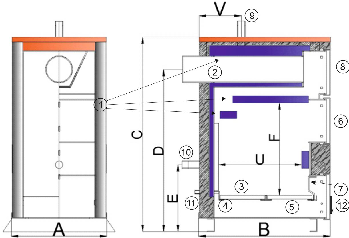
6.1 Котел состоит: теплообменник (водяная рубашка) (поз. 1), дымоход (поз2). В нижней части топки устанавливаются колосники (поз. 3) на опоры (поз. 4), зольник (поз. 5). К передней стенке корпуса котла на оси присоединяются загрузочная дверца (поз. 6), дверца для обслуживания (поз. 7), дверца для чистки теплообменника (поз.8), патрубок подающего трубопровода (поз.9), патрубок обратного трубопровода (поз.10), патрубок для слива воды с котла (поз.11), дверца зольника (поз.12).
